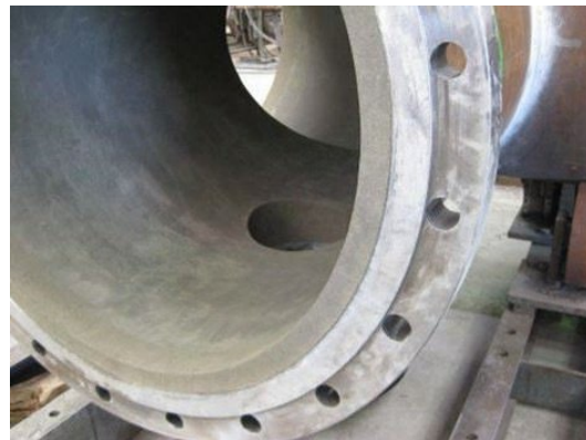
tubería revestida de hormigón
