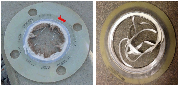
Imágenes de juntas de aislamiento expuestas a medios y productos químicos ataque.
