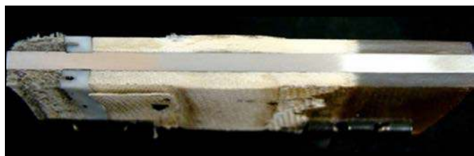
Attaque de vapeur sur un joint d'étanchéité GRE
