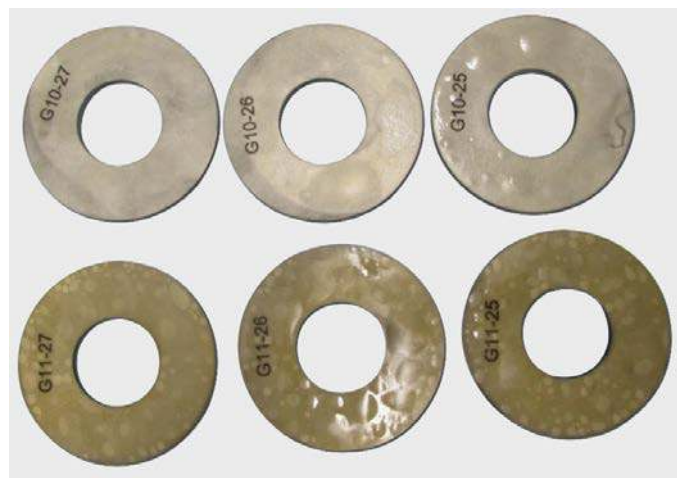
Attaque chimique (H 2 S) sur un joint d'étanchéité GRE
